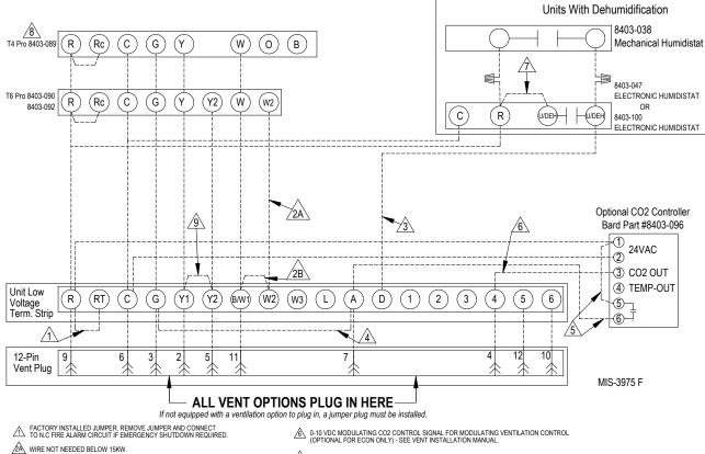
INSTALL JUMPER FOR 1 STAGE ELECTRIC HEAT ON UNITS WITH MORE THAN 10KW.
