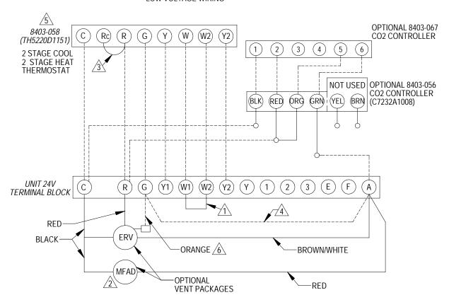
REMOVE JUMPER FOR 2 STAGE ELECTRIC HEAT ON UNITS WITH 15 OR MORE KW
