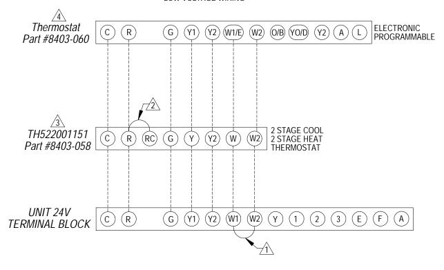
REMOVE JUMPER FOR 2 STAGE ELECTRIC HEAT ON UNITS WITH 15 OR MORE KW
