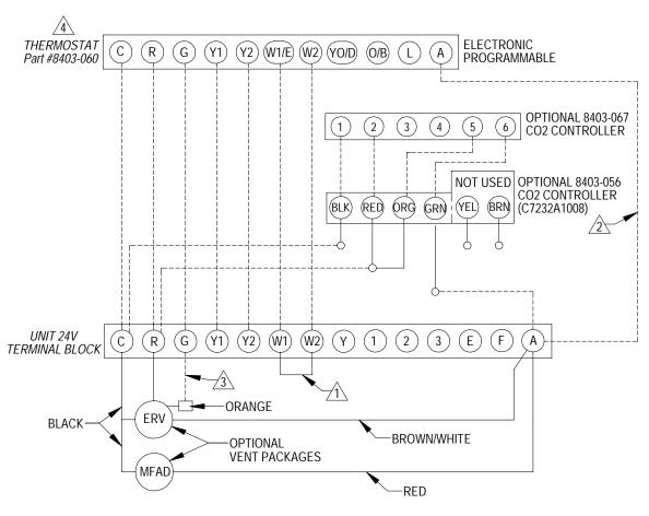
REMOVE JUMPER FOR 2 STAGE ELECTRIC HEAT ON UNITS WITH 15 OR MORE KW
