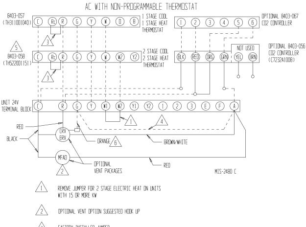
FACTORY INSTALLED JUMPER
