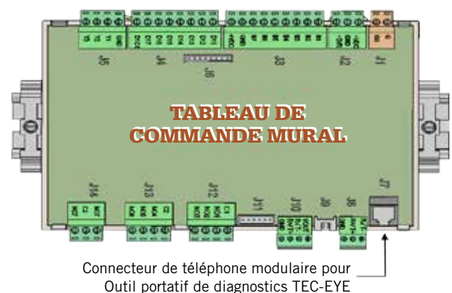
FIGURE 2.14 Connexion du TEC-EYE au régulateur
