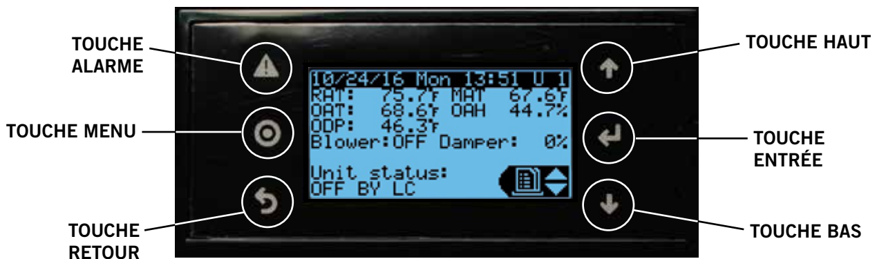
FIGURE 2.1 Écran et interface TEC-EYE™ (référence Bard 8301-059) (écran d'état illustré)
