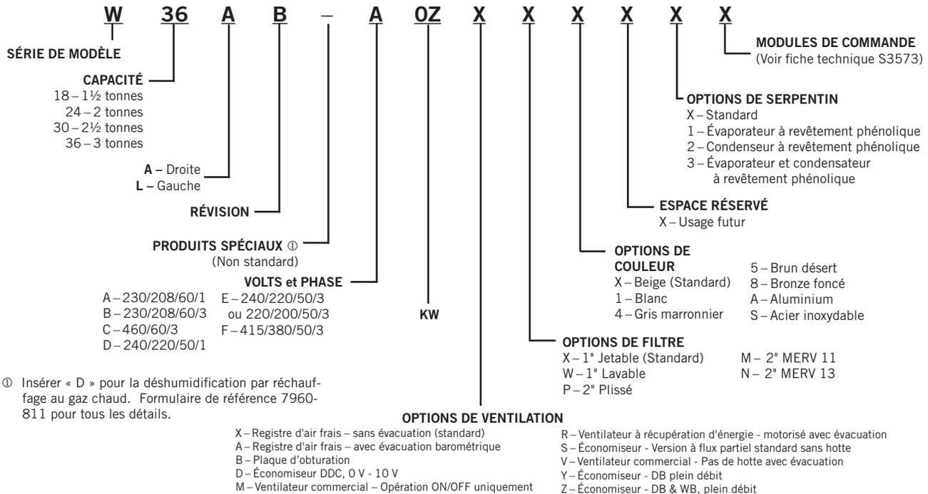
① Insérer « D » pour la déshumidification par réchauffage au gaz chaud. Formulaire de référence 7960-811 pour tous les détails.
