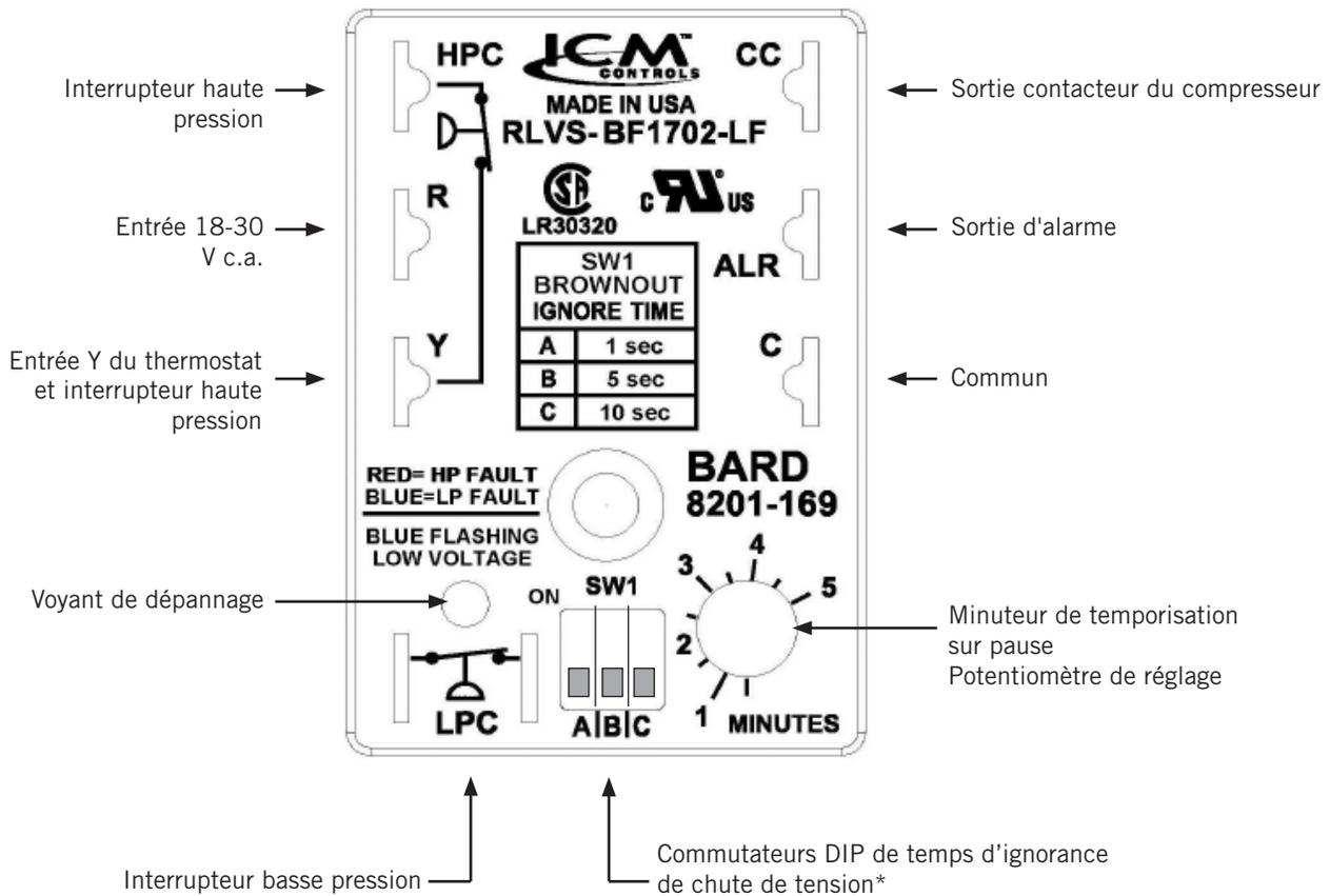
\* Activer un seul commutateur pour ce réglage de temps d'ignorance spécifique. 1500 millisecondes est la durée maximale d'ignorance de la chute de tension. Si tous les commutateurs sont « OFF », le contrôle est en « ne pas ignorer ».
