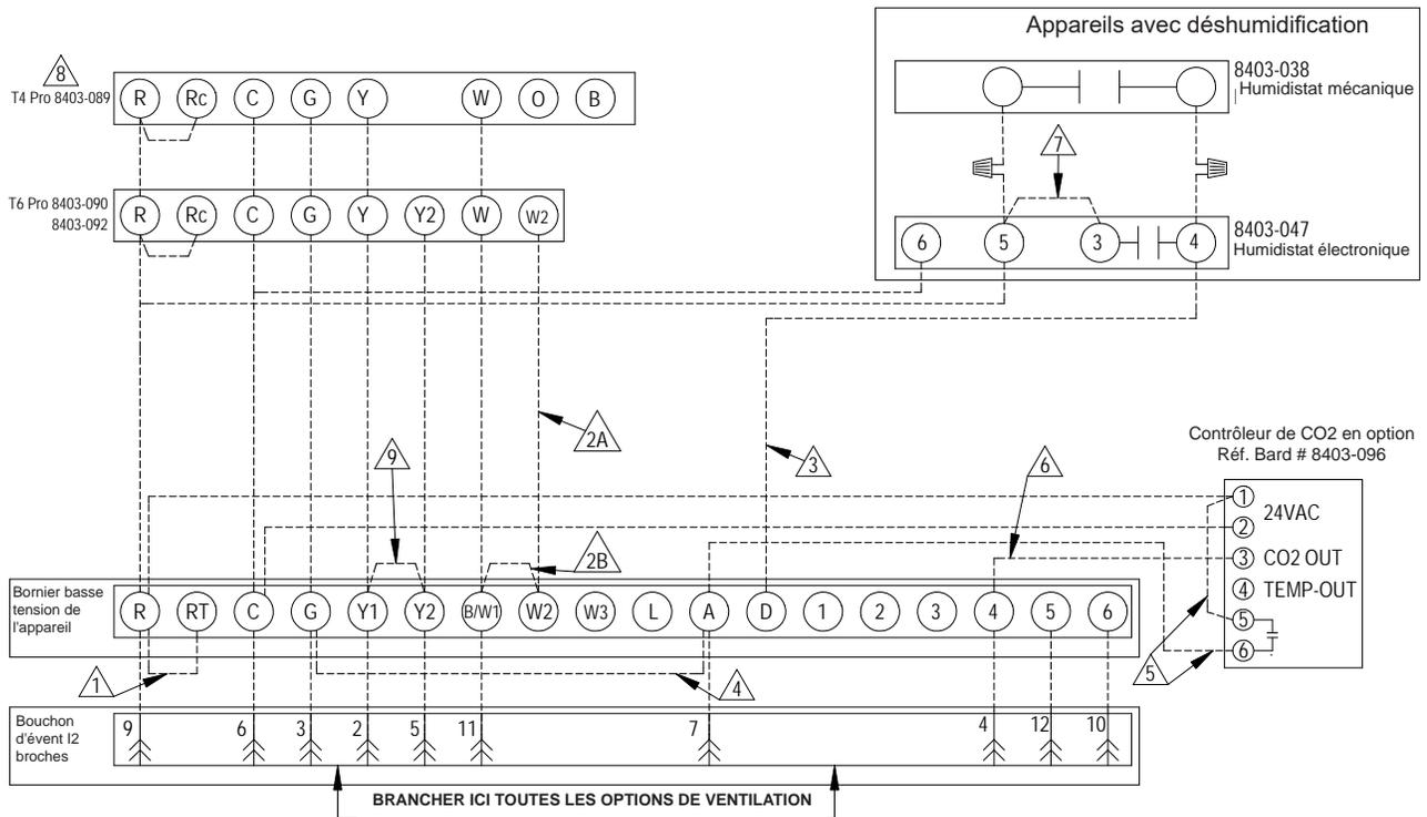
*S'il n'est pas équipé d'une option de ventilation à brancher, un cavalier doit être installé.*
