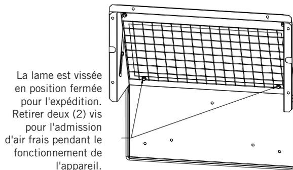
La lame est vissée en position fermée pour l'expédition. Retirer deux (2) vis pour l'admission d'air frais pendant le fonctionnement de l'appareil.
