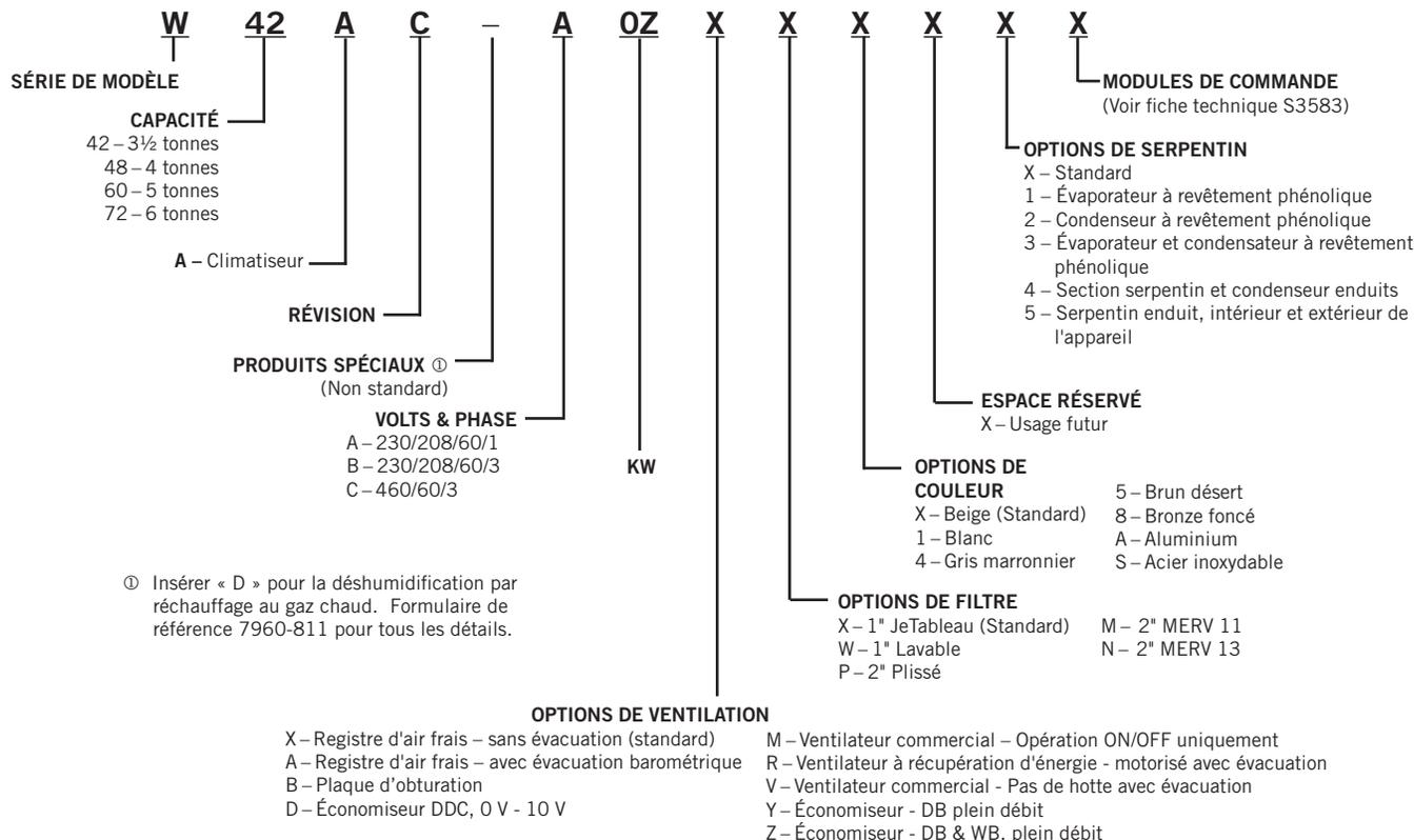
**NOTE :** les options de ventilation X et B n'ont pas de capacité d'évacuation. Peut nécessiter une décharge barométrique séparée fournie sur place dans le bâtiment.
