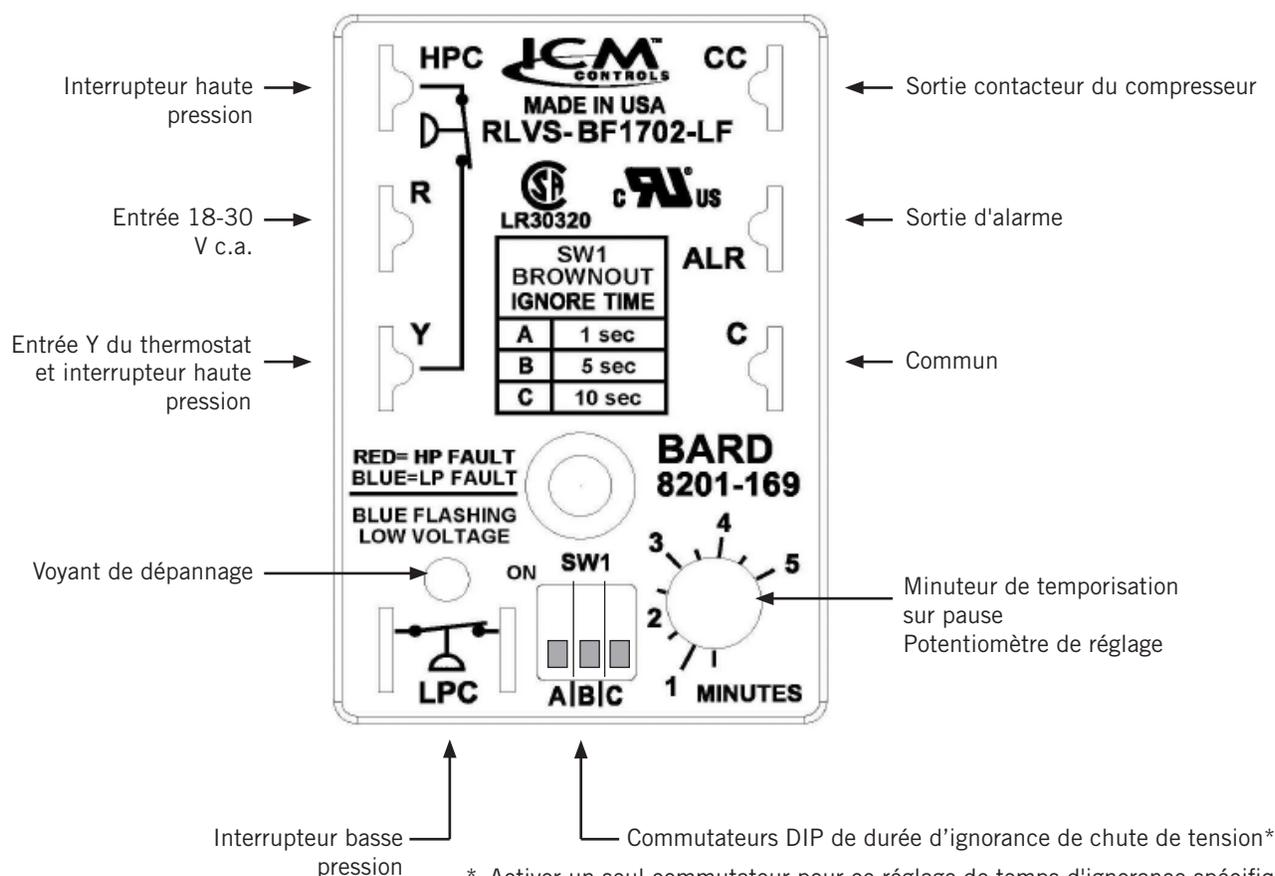
\* Activer un seul commutateur pour ce réglage de temps d'ignorance spécifique. 10 secondes est la durée maximale d'ignorance de la chute de tension. Si tous les commutateurs sont « éteints », le contrôle est dans « ne pas ignorer ».
