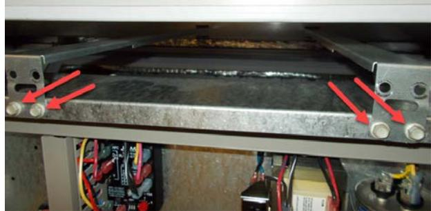
3. Tirer les supports vers l'avant de l'appareil. L'arrière du support glissera hors des fentes supérieures à l'arrière du plateau de filtre.
