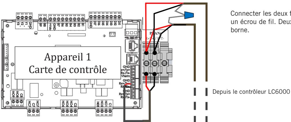
Connecter les deux fils de drain avec un écrou de fil. Deux fils maximum par borne.
