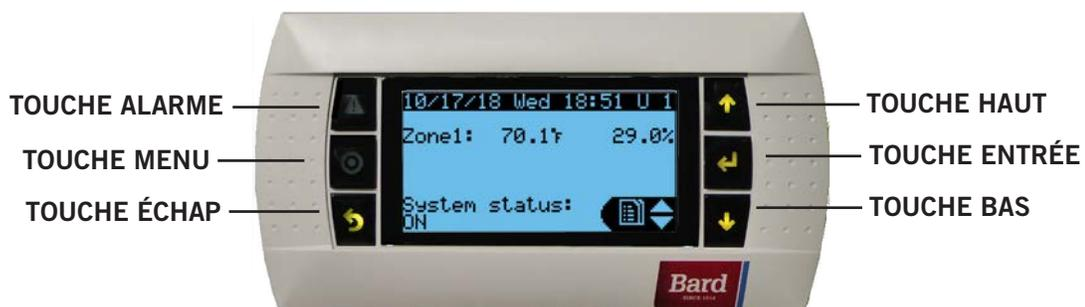
Les fonctions des touches de l'interface du contrôleur LC6000 sont les mêmes que celles du TEC-EYE, figure 28, page 34.
