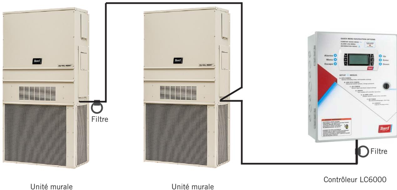
Outre la méthode de branchement « en série » du câblage de communication, illustrée en figure 18, les appareils murales peuvent également être connectés comme indiqué sur la figure 19. Si cette dernière méthode est choisie, veiller à placer les filtres des fils de communication dans les positions indiquées sur la figure 19. Consulter la figure 20 pour plus d'informations sur le positionnement des filtres en fonction de la méthode de câblage.
