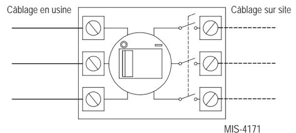
**REMARQUE :** Les points de connexion du modèle à accès par la droite sont illustrés, le modèle à accès par la gauche est simplement l'image miroir de cette illustration.
