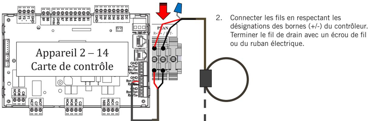
2. Connecter les fils en respectant les désignations des bornes (+/-) du contrôleur. Terminer le fil de drain avec un écrou de fil ou du ruban électrique.
