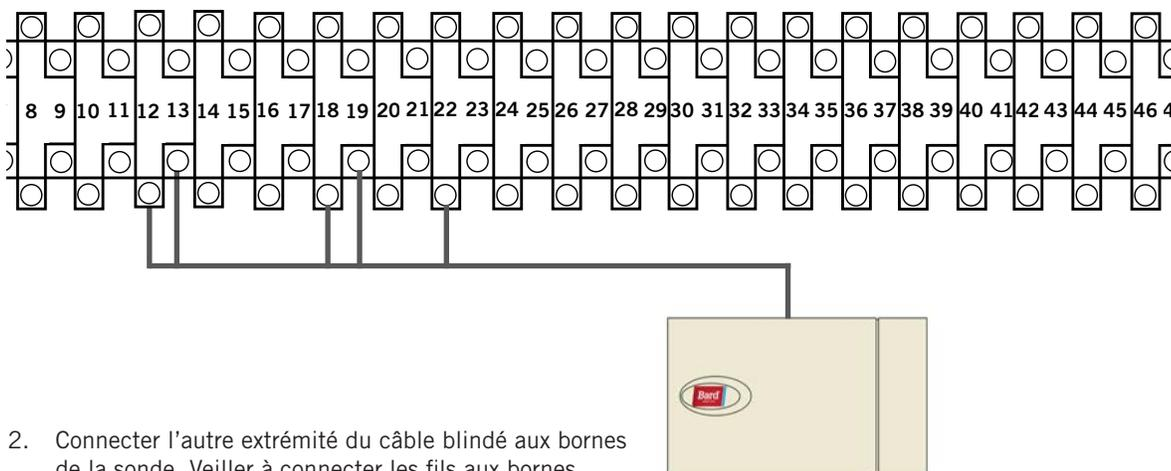
2. Connecter l'autre extrémité du câble blindé aux bornes de la sonde. Veiller à connecter les fils aux bornes appropriées, comme indiqué dans le tableau ci-dessus.
