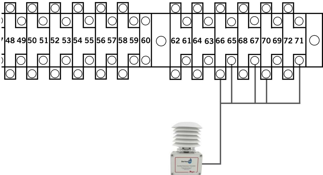
2. Connecter l'autre extrémité du câble blindé aux bornes de la sonde. Veiller à connecter les fils aux bornes appropriées, comme indiqué dans le tableau ci-dessus.
