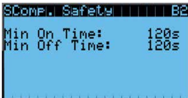
FIGURA 33 Ajuste de los retardos del compresor
