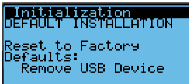
FIGURA 10 Restauración de la configuración predeterminada de fábrica - Quitar dispositivo USB
