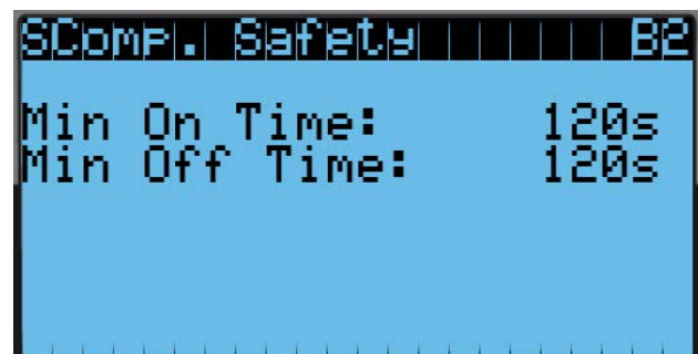
FIGURA 38 Ajuste de los retardos del compresor
