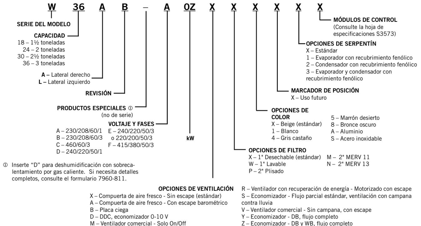
① Inserte "D" para deshumidificación con sobrecalentamiento por gas caliente. Si necesita detalles completos, consulte el formulario 7960-811.
