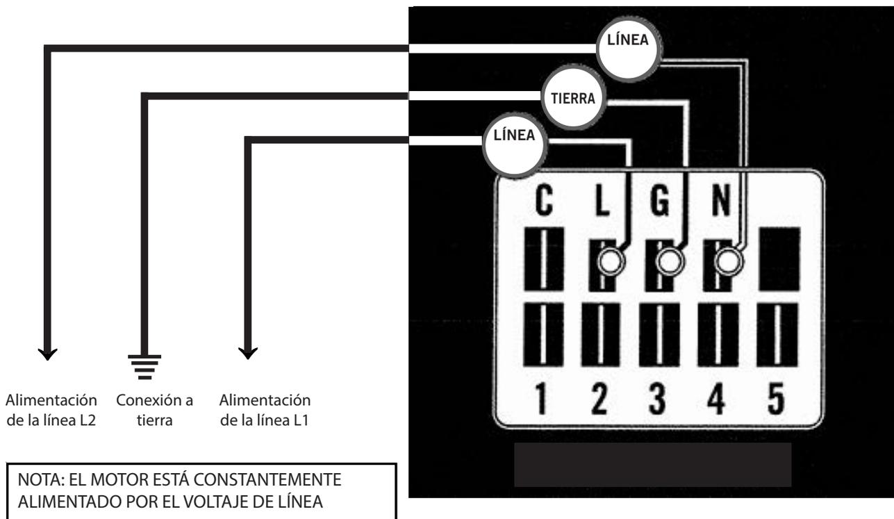
2. Verifique si en las conexiones L/L1, G y N/L2 del motor el voltaje tiene el valor adecuado y la tierra está bien conectada y, a continuación, siga las indicaciones de la sección "Diagnósticos del motor SelecTech".
