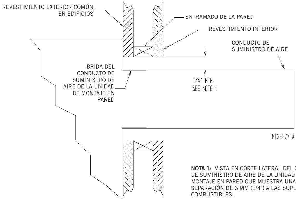
**NOTA 1:** VISTA EN CORTE LATERAL DEL CONDUCTO DE SUMINISTRO DE AIRE DE LA UNIDAD DE MONTAJE EN PARED QUE MUESTRA UNA SEPARACIÓN DE 6 MM (1/4") A LAS SUPERFICIES COMBUSTIBLES.
