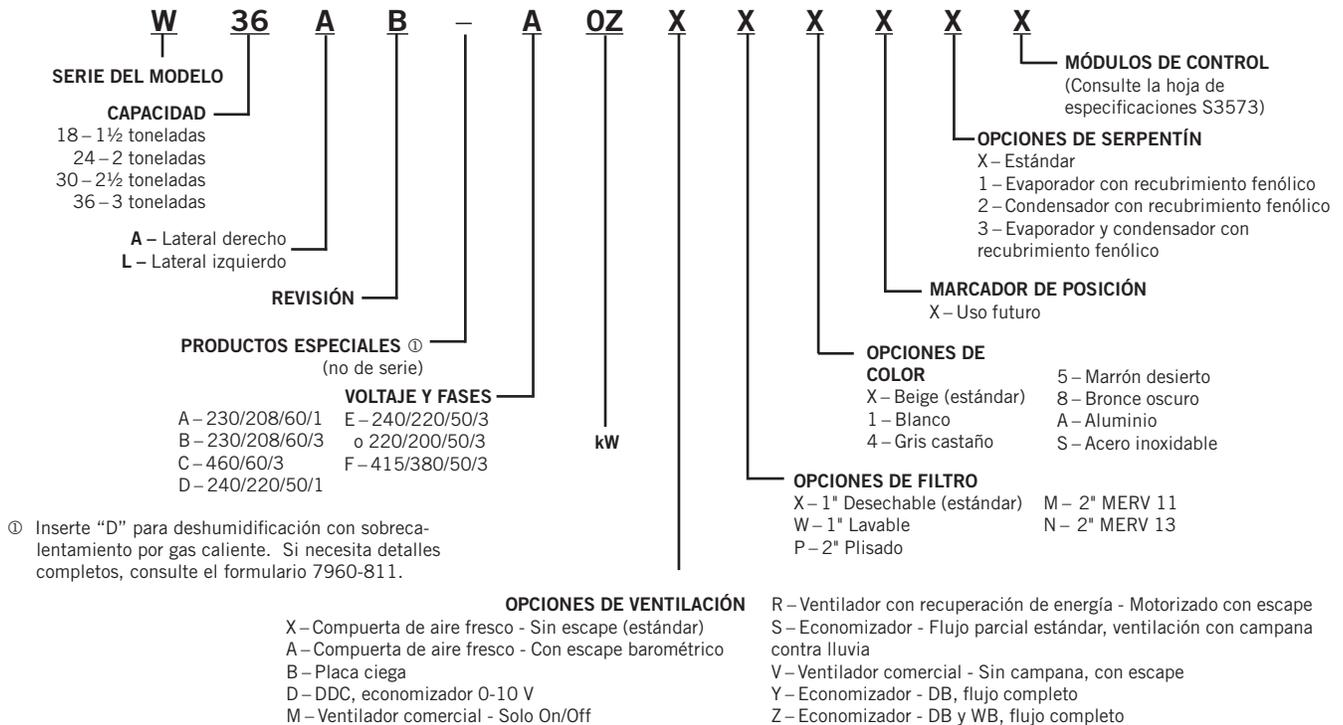
**NOTA:** las opciones de ventilación X y B no tienen posibilidad de instalar un escape. Es posible que requieran un regulador barométrico por separado en la instalación.
