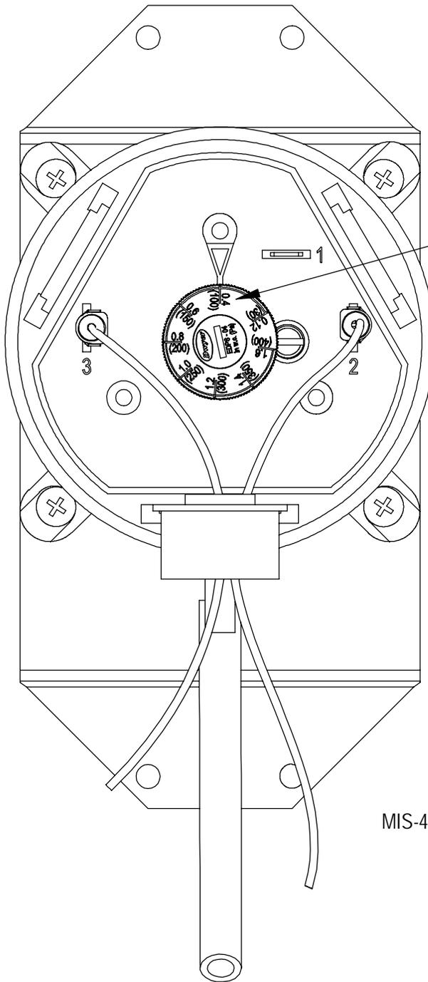
Gire en el sentido de las agujas del reloj para aumentar la cantidad de restricción necesaria para activar el interruptor y en sentido contrario a las agujas del reloj para disminuir la cantidad de restricción
