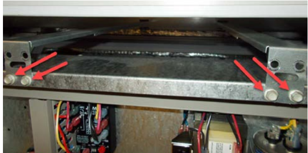
FIGURA 6 Retire los cuatro tornillos
