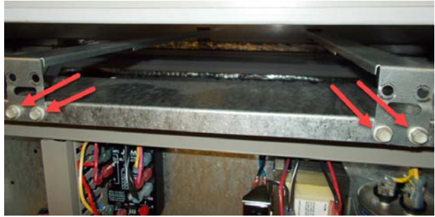
FIGURA 6 Retire los cuatro tornillos
