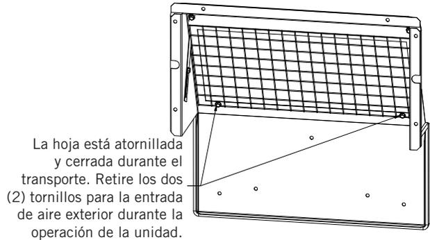
La hoja está atornillada y cerrada durante el transporte. Retire los dos (2) tornillos para la entrada de aire exterior durante la operación de la unidad.
