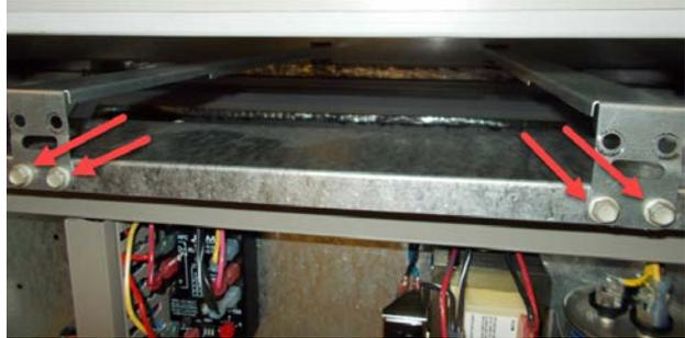
3. Tire de los soportes hacia el frente de la unidad. La parte posterior del soporte se deslizará fuera de las ranuras superiores en la parte posterior de la bandeja del filtro.
