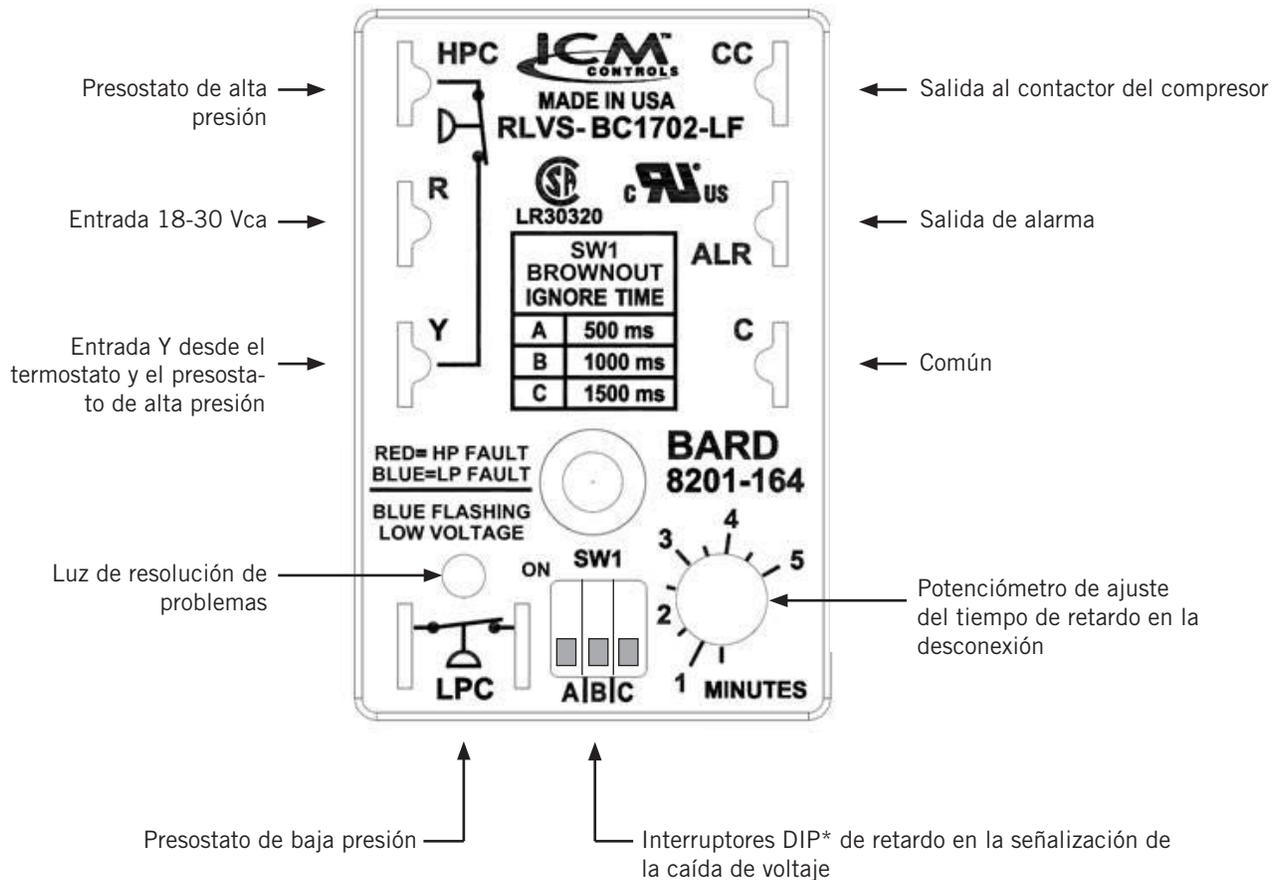
\* Encienda sólo el interruptor para el tiempo específico durante el cual desea ignorar la caída de voltaje. 10 segundos es el tiempo máximo durante el cual se puede ignorar la caída de voltaje. Si todos los interruptores están "apagados", el control está en "no ignorar".
