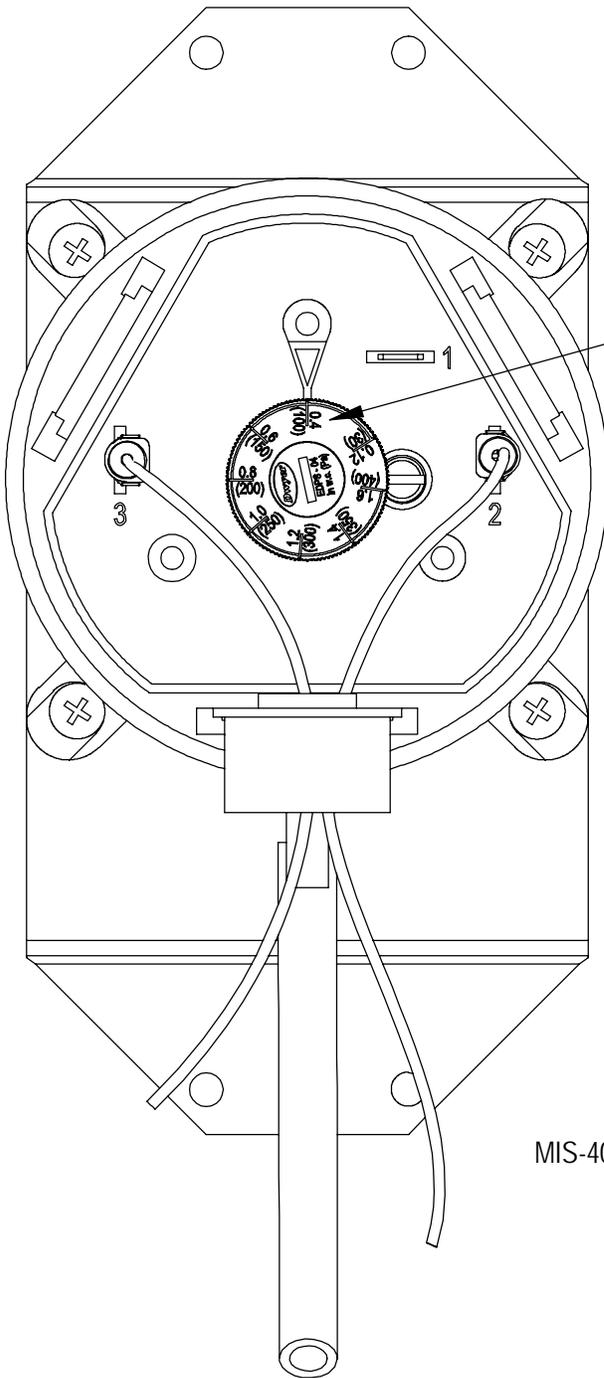
Gire en el sentido de las agujas del reloj para aumentar la cantidad de restricción requerida para activar el swtich y en sentido contrario a las agujas del reloj para disminuir la cantidad de restricción
