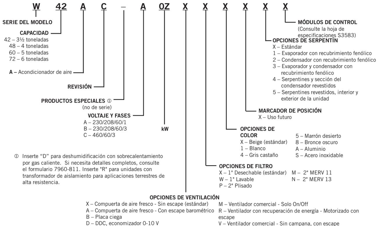
**NOTA:** las opciones de ventilación X y B no tienen posibilidad de instalar un escape. Es posible que requieran un regulador barométrico por separado en la instalación.
