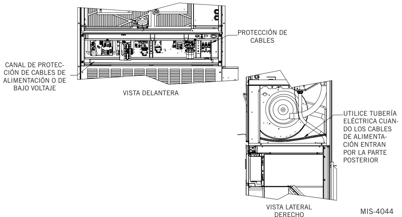
cables por debajo del canal de cables y a la derecha del canal de cables junto al contactor del compresor y luego hacia arriba al panel de control superior donde se realizan las conexiones. Si el cableado de la alimentación entra en la unidad por el lado derecho, los cables de bajo voltaje se pueden pasar por debajo del canal de cables para acceder a la regleta de terminales de bajo voltaje.
