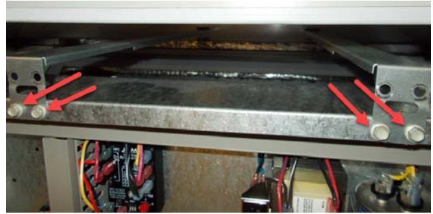
FIGURA 6 Retire los cuatro tornillos
