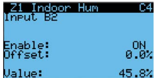
FIGURA 35 Habilitar/inhabilitar sensor de humedad interior de zona 1
