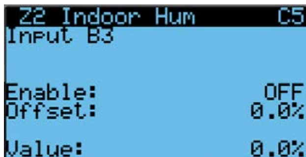
FIGURA 37 Habilitar/inhabilitar sensor de humedad interior de zona 2
