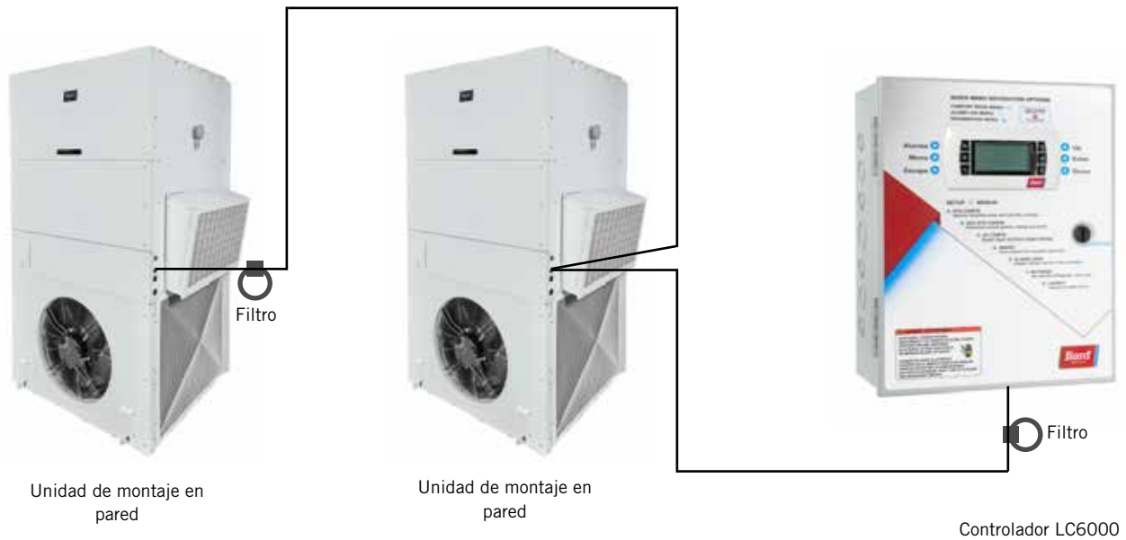
FIGURA 20 Cableado de comunicación (conexión en cadena)
