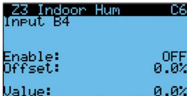
FIGURA 38 Habilitar/inhabilitar sensor de humedad interior de zona 3
