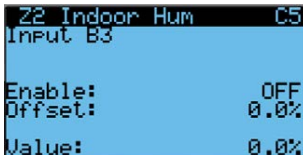
FIGURA 37 Habilitar/inhabilitar sensor de humedad interior de zona 2
