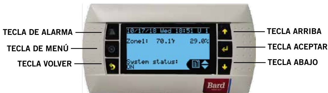
FIGURA 34 Pantalla e interfaz del controlador LC6000 (se muestra la pantalla de estado)
