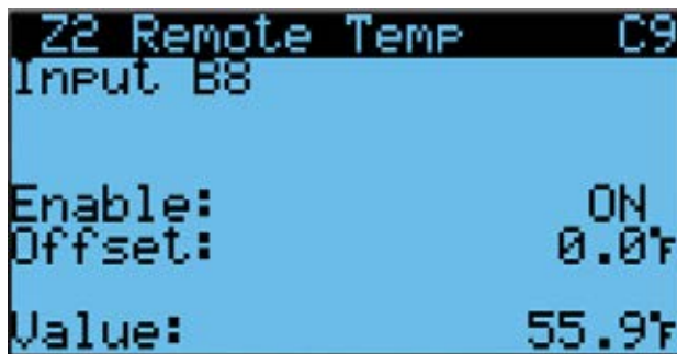
FIGURA 41 Habilitar/inhabilitar sensor de temperatura remoto de zona 2
