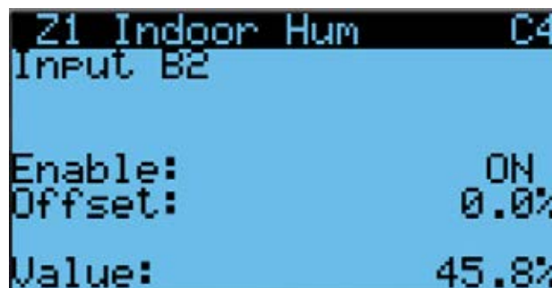
FIGURA 36 Habilitar/inhabilitar sensor de humedad interior de zona 1
