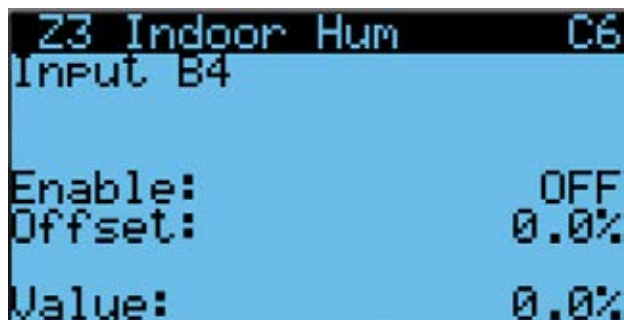
FIGURA 38 Habilitar/inhabilitar sensor de humedad interior de zona 3
