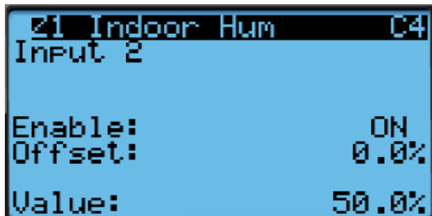
FIGURA 48 Ajuste del valor de compensación del sensor
