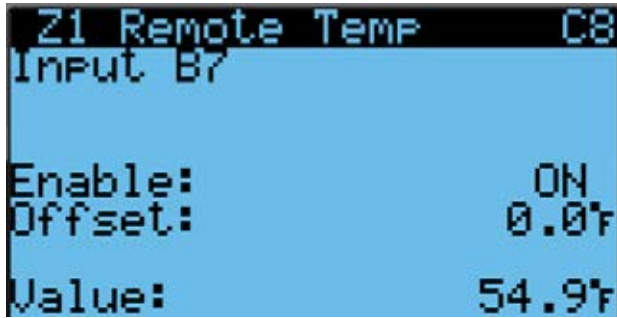
FIGURA 40 Habilitar/inhabilitar sensor de temperatura remoto de zona 1
