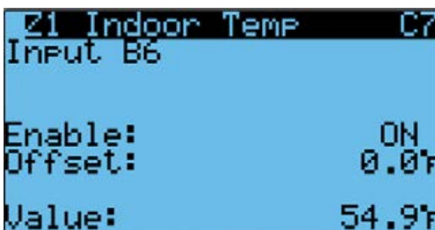
FIGURA 39 Habilitar/inhabilitar sensor de temperatura interior de zona 1
