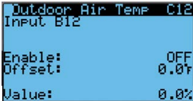
FIGURA 44 Habilitar/inhabilitar sensor de temperatura del aire exterior
