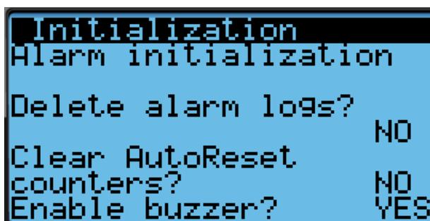
Después de que cada una de las unidades haya sido direccionada, se haya realizado la auto prueba y se hayan borrado los registros de alarma, el resto de la configuración del sistema puede continuar.
