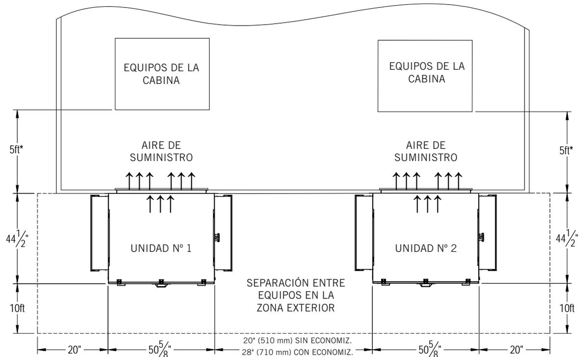
\* Distancia recomendada entre la abertura del aire de retorno y los equipos montados en la cabina o sala. El suministro de aire debe ser capaz de proveer una circulación de aire adecuada en todo el espacio.
