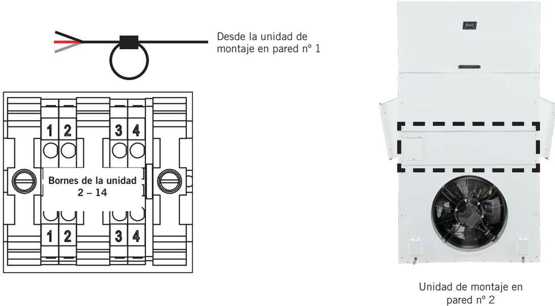
1. Tienda el cable desde la primera unidad de montaje en pared hasta el bloque de bornes de la segunda unidad de montaje en pared. Si esta es la última unidad que se va a conectar, haga un pequeño bucle de servicio en el cable y coloque el filtro EMI como muestra la figura.
