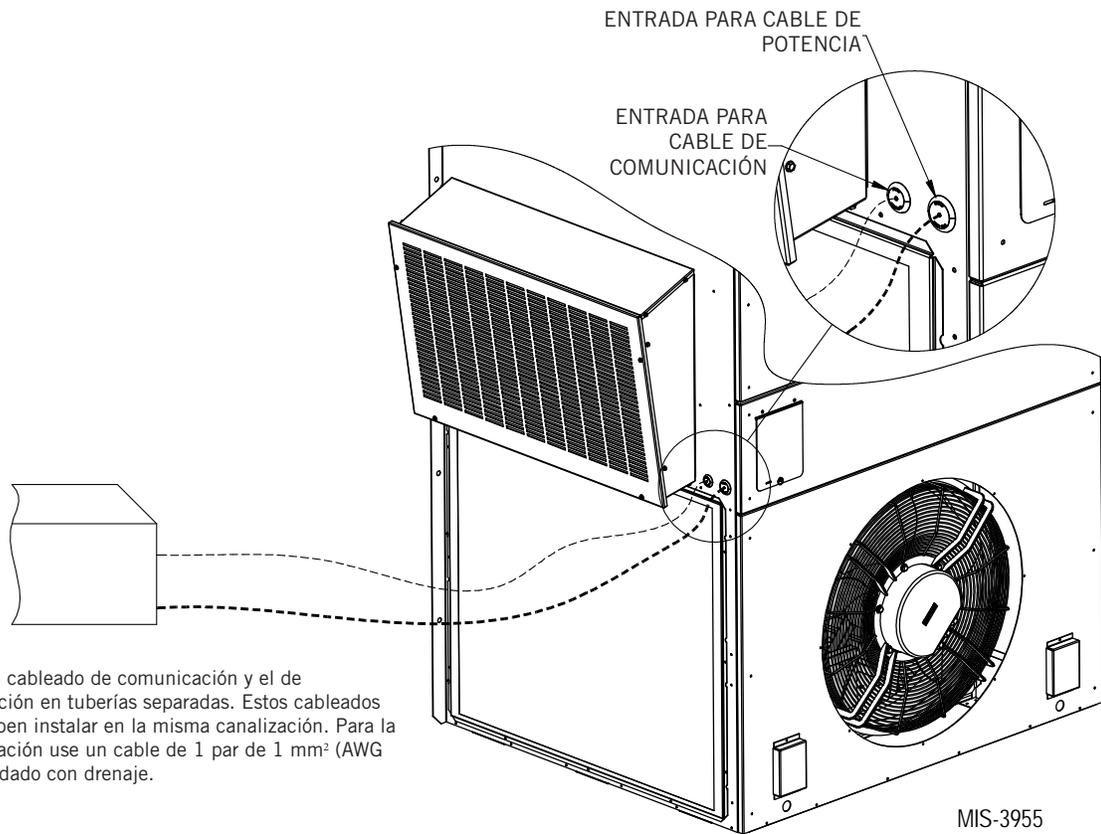
Tienda el cableado de comunicación y el de alimentación en tuberías separadas. Estos cableados no se deben instalar en la misma canalización. Para la comunicación use un cable de 1 par de 1 mm<sup>2</sup> (AWG 18), blindado con drenaje.
