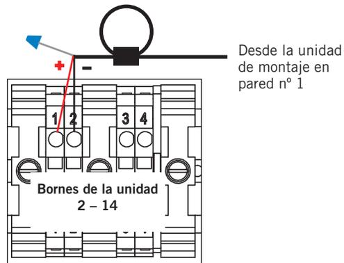
3. Continúe conectando en cadena las restantes unidades ("+" con "+", "-" con "-") y colocando tuercas de cable para unir los drenajes hasta la última unidad. **Conecte el filtro EMI en la última unidad como se muestra arriba.** Se pueden conectar y controlar hasta 14 unidades de montaje en pared con un solo controlador LC6000.
