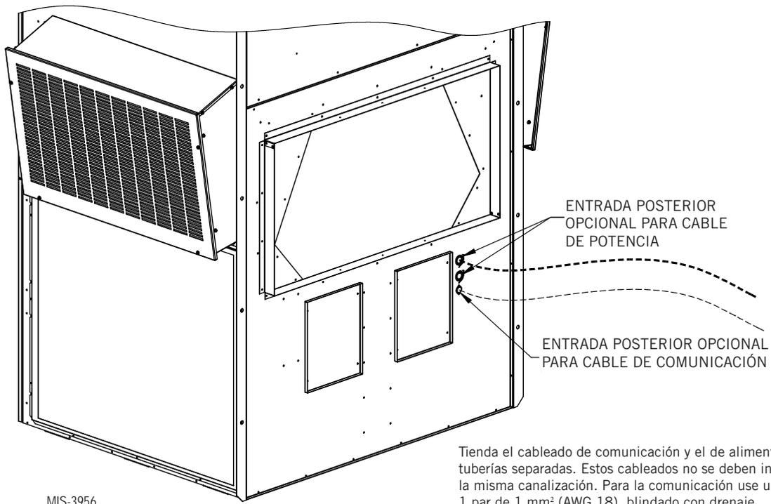
Tienda el cableado de comunicación y el de alimentación en tuberías separadas. Estos cableados no se deben instalar en la misma canalización. Para la comunicación use un cable de 1 par de 1 mm<sup>2</sup> (AWG 18), blindado con drenaje.
