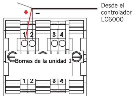
3. Conecte otro cable junto con el anterior ("conexión en cadena") y tiéndalo en una tubería hasta la segunda unidad de montaje en pared. Conecte ambos conductores de drenaje con una tuerca de cable. Cada borne admite un máximo de dos cables.
