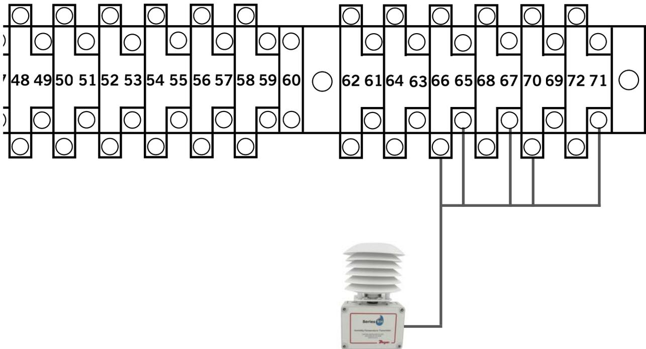
2. Conecte el otro extremo del cable blindado a los bornes del sensor. Asegúrese de que los cables estén conectados en los bornes correctos como se muestra en la tabla anterior.
