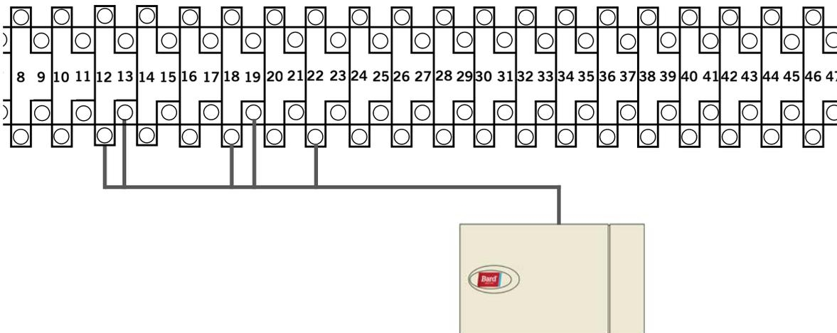
2. Conecte el otro extremo del cable blindado a los bornes del sensor. Asegúrese de que los cables estén conectados en los bornes correctos como se muestra en la tabla anterior.
