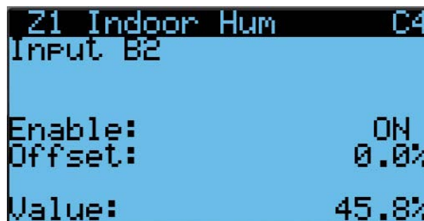
FIGURA 36 Habilitar/inhabilitar sensor de humedad interior de zona 1
