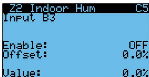
FIGURA 37 Habilitar/inhabilitar sensor de humedad interior de zona 2
