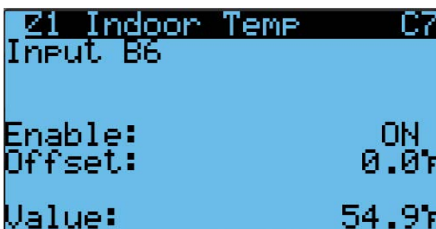
FIGURA 39 Habilitar/inhabilitar sensor de temperatura interior de zona 1
