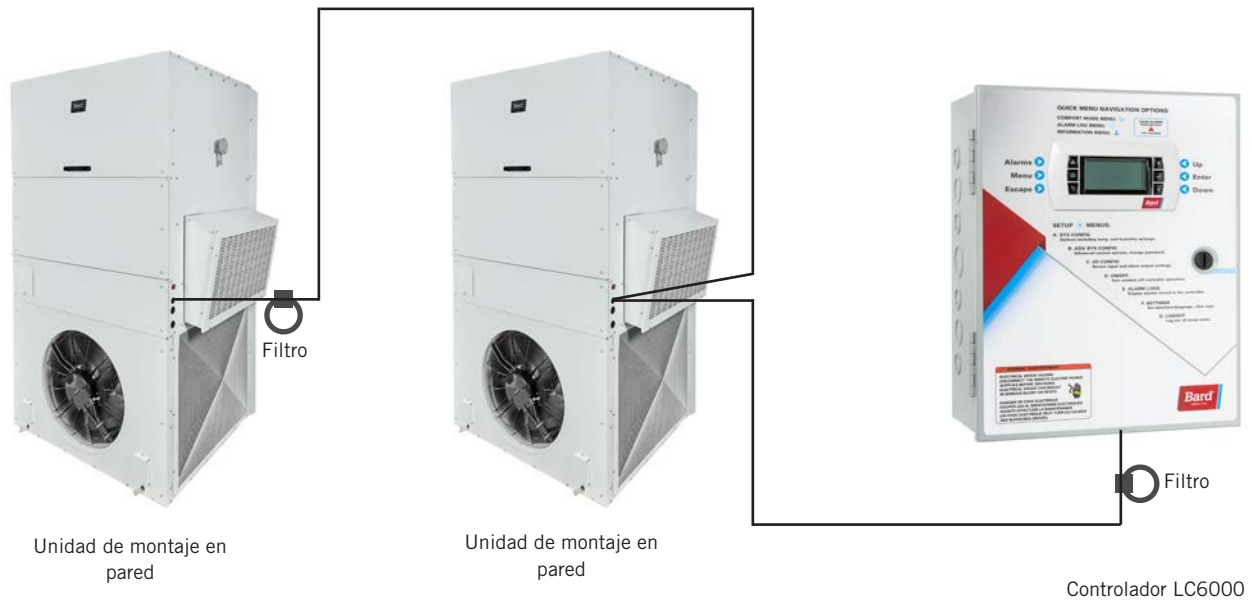
FIGURA 20 Cableado de comunicación (conexión en cadena)
