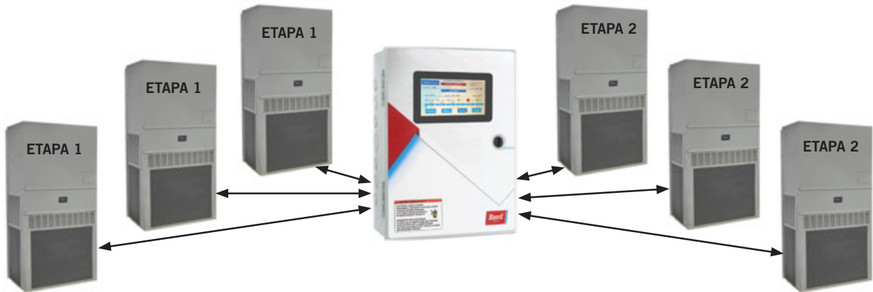
FIGURA 15 Hermanamiento triple: operación simultánea de unidades
